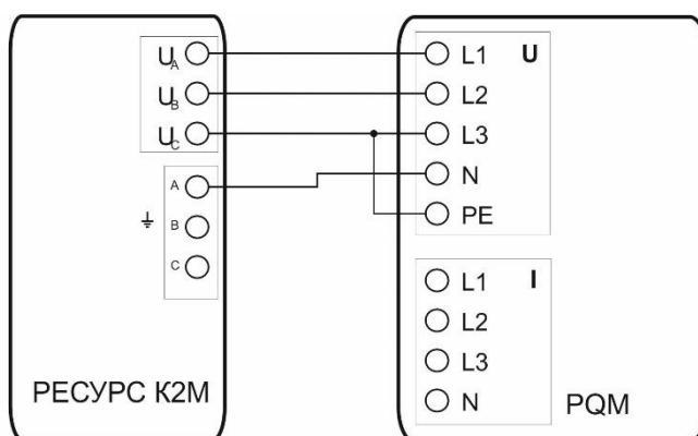
Рисунок 2 – Структурная схема определения абсолютной погрешности измерения среднеквадратического значения и суммарного коэффициента гармонических (интергармонических) составляющих напряжения.
