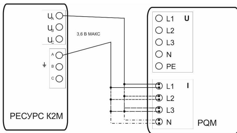
Рисунок 3 – Структурная схема определения абсолютной погрешности измерения среднеквадратического значения и суммарного коэффициента гармонических (интергармонических) составляющих силы тока.
