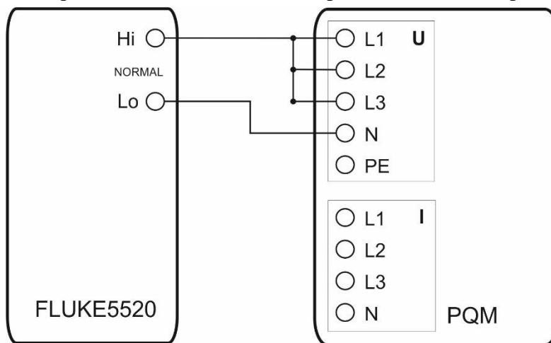
Рисунок 7 – Структурная схема определения абсолютной погрешности измерения кратковременной и длительной дозы фликера, длительности регистрируемых событий.
