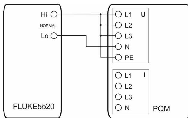
Рисунок 1 – Структурная схема определения абсолютной погрешности измерения напряжения постоянного и переменного тока, частоты переменного тока.
