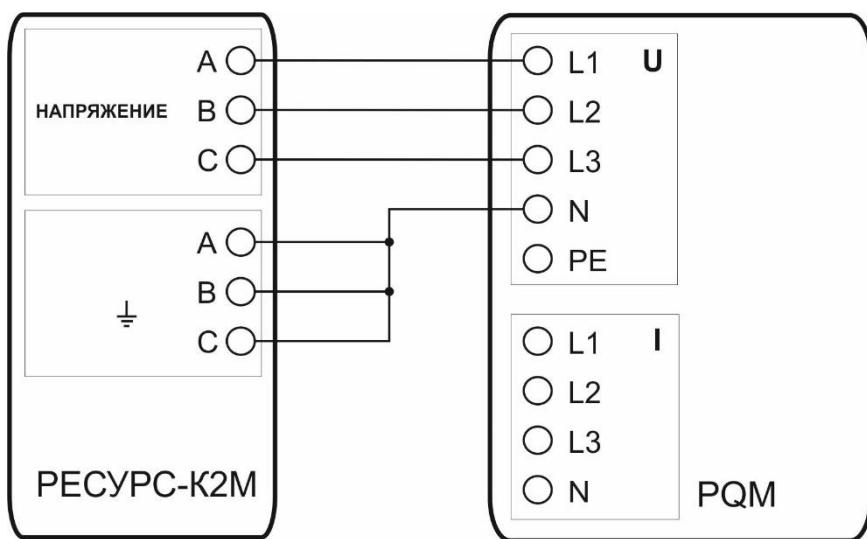
Рисунок 8 – Структурная схема определения абсолютной погрешности измерения коэффициента несимметрии напряжений по обратной и прямой последовательности, угла сдвига фаз напряжений.
