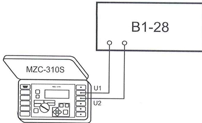
Рисунок 1 – Структурная схема определения абсолютной погрешности измерения напряжения постоянного тока, действующего значения напряжения переменного тока тока, частоты переменного тока,
