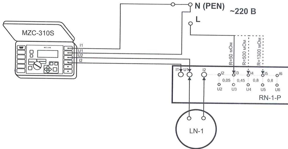
Рисунок 5 – Структурная схема определения абсолютной погрешности измерения полного сопротивления цепи 4-х проводным методом ,
