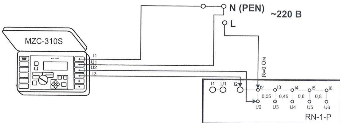
Рисунок 4 – Структурная схема определения абсолютной погрешности измерения активного и реактивного сопротивления цепи 4-х проводным методом ,
