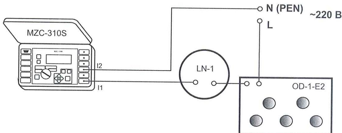
Рисунок 3 – Структурная схема определения абсолютной погрешности измерения полного сопротивления цепи 2-х проводным методом ,
