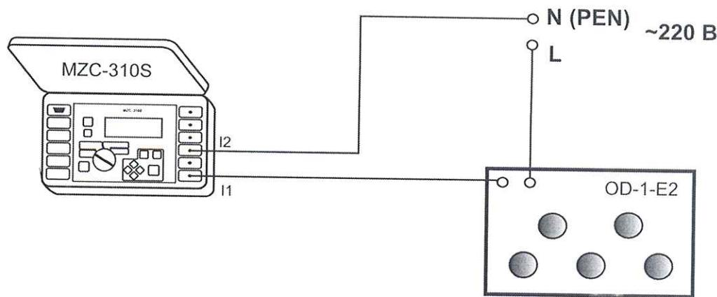
Рисунок 2 – Структурная схема определения абсолютной погрешности измерения активного и реактивного сопротивления цепи 2-х проводным методом ,
