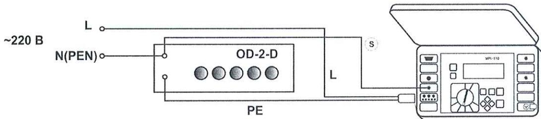
Рисунок 10 – Структурная схема определения погрешности измерения электрического сопротивления заземления,
