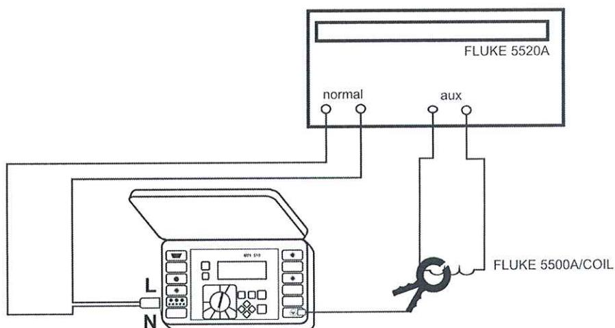
Рисунок 3 – Структурная схема определения абсолютной погрешности измерения полной мощности,
