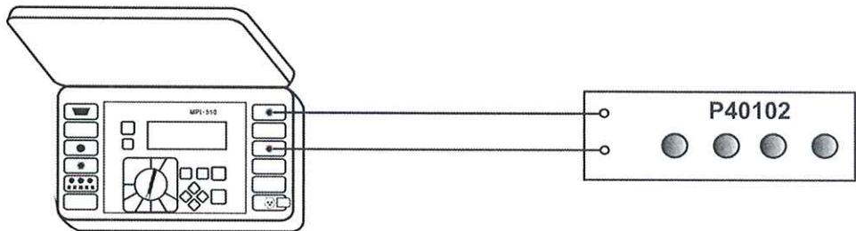
Рисунок 13а – Структурная схема определения погрешности измерения сопротивления изоляции (п.п. 1-9 таблиц А.16, А.17, А.18 приложения А),
