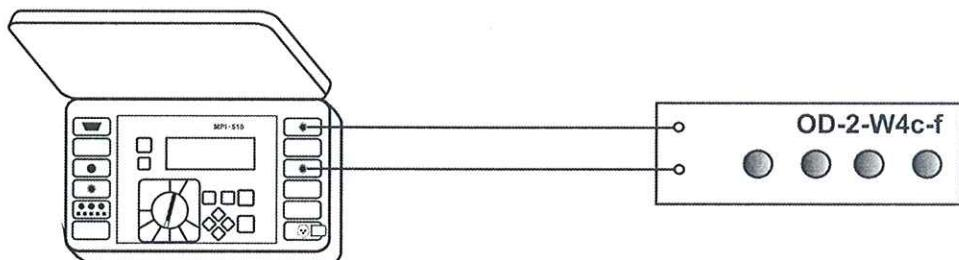
Рисунок 13б – Структурная схема определения погрешности измерения сопротивления изоляции (п.п. 10-12 таблиц А.16, А.17 приложения А; п.п. 10-15 таблицы А.18 приложения А),
