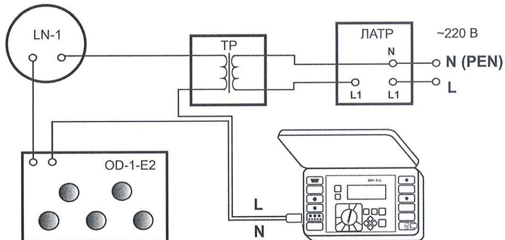
Рисунок 4 – Структурная схема определения погрешности измерения полного электрического сопротивления цепи «фаза-нуль»,
