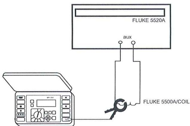
Рисунок 2 – Определение абсолютной погрешности измерения действующего значения силы переменного тока,
