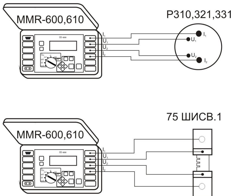
Рисунок 2 – Структурная схема определения абсолютной погрешности измерения электрического сопротивления,
