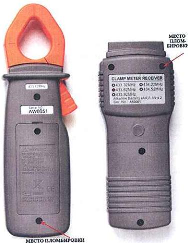
Рисунок 2 – Схема пломбировки от несанкционированного доступа.
