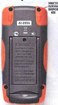
Рисунок 2 – Схема пломбировки от несанкционированного доступа.
